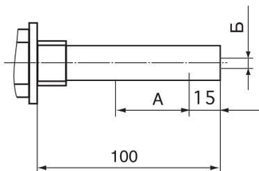
А, Б – рабочая зона, соответственно, при вертикальной и горизонтальной установке
