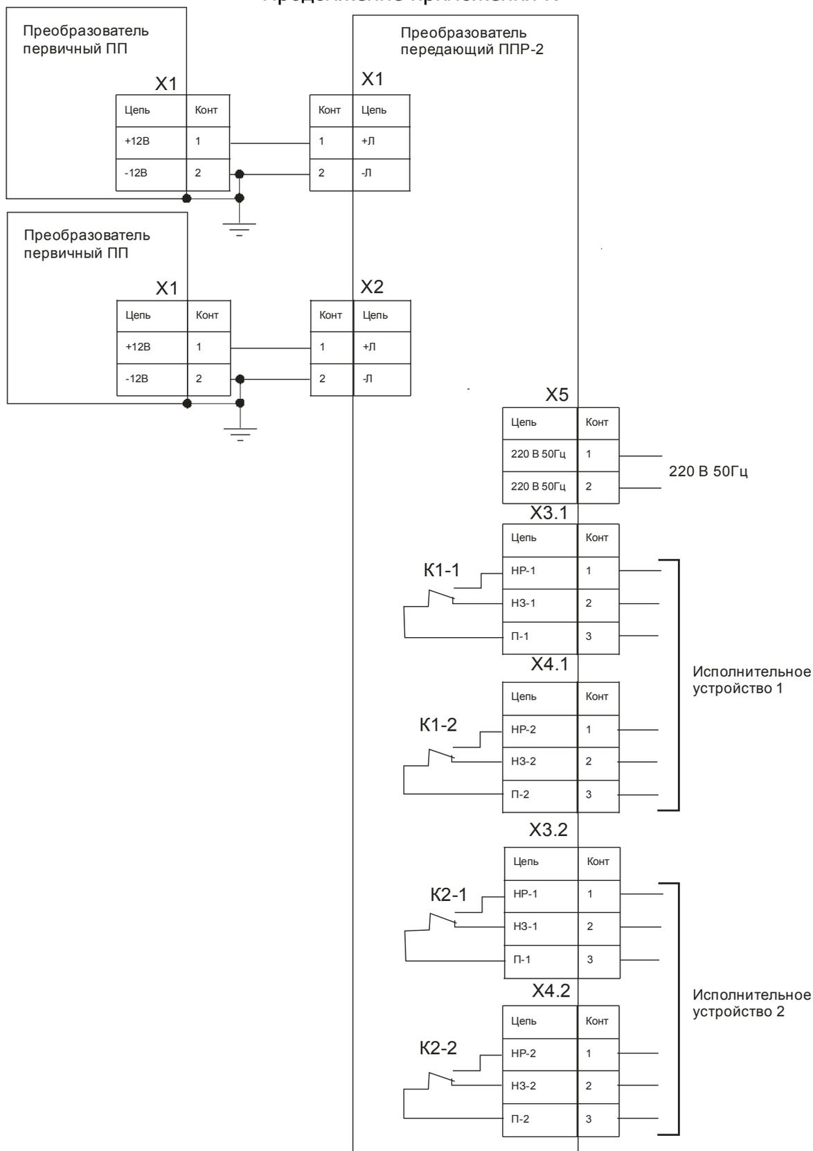
**Рис. К.2 - Схема подключения РОС 102
