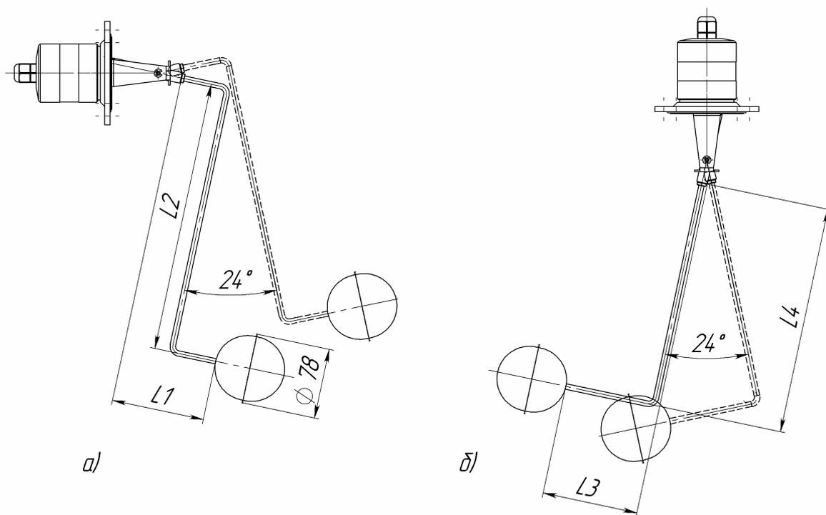
Рис. Б 2 - Датчик с изогнутым рычагом
