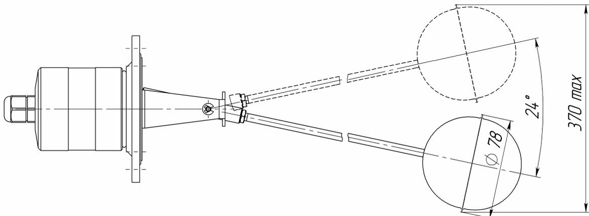
Рис. Б 1 - Датчик с прямым рычагом
