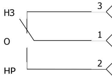
Изображенное состояние контактов соответствует отсутствию жидкости
