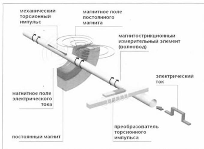
Точное определение позиции получается измерением времени между стартом токового импульса и времени возникновения ответного электрического сигнала, которое определяется в преобразователе торсионных импульсов при детектировании ультразвуковой волны[2].
